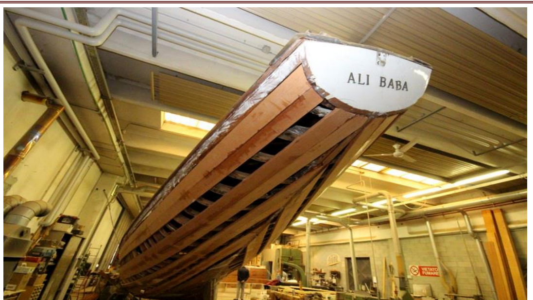
Ali Babà 1925 in restauro al cantiere Ernesto Riva
